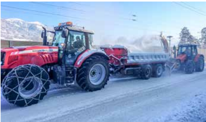
Schnee wird mittels einer Fräse auf den Traktoranhänger verladen und abtransportiert.
