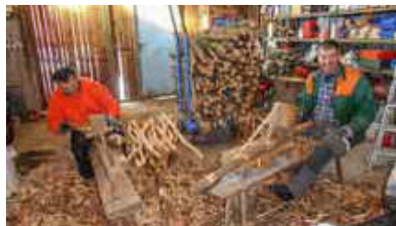
Frank und Armin schälen über den Winter die Äste für den Scheienzaun. Aufgestellt wird er im Frühjahr.
