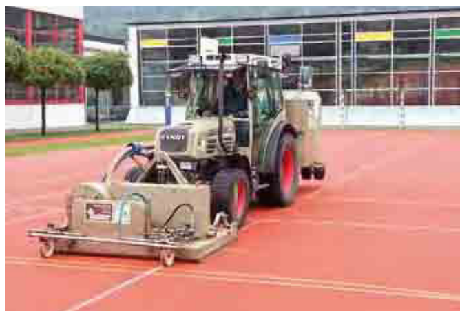
Tiefenreinigung des Belages
