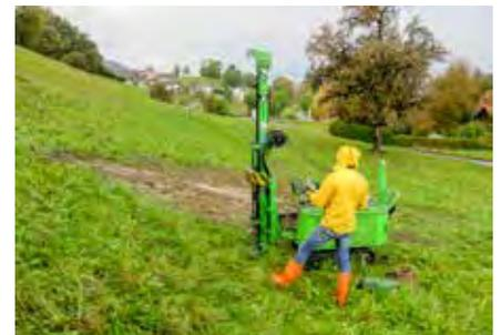
Im flachen Gelände werden Rammsondierungen gemacht. Der Flurschaden ist geringer.
