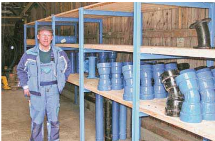
Schwere Formstücke erfordern stabile Regale, welche in Eigenregie gefertigt wurden.
